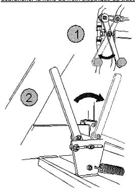
Ne pas oublier de fermer la poignée de couplage ( la poignée 1 doit être sortie) et de coupler avec la poignée de couplage.
