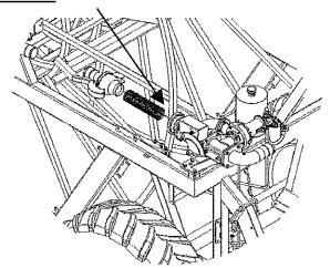
Vérifiez que le tuyau soit bien aligné sur l'enrouleur. Contrôlez régulièrement le piton de trancannage de la commande du tuyau
