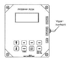
Au cours du déplacement de la machine, le CONTACT CULBUTEUR doit se trouver au milieu (déplacement) de manière à ce qu'il ne puisse pas être placé en position zéro en cours de route. Une fois le déplacement terminé. Basculer le CONTACT CULBUTEUR vers le bas (service).
