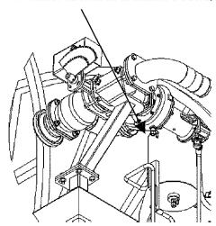
Pour les machines équipées d'un arrêt haute tension, appuyer sur START, afin d'ouvrir la soupape principale pour permettre à l'eau de s'écouler librement. (Démonter la conduite menant à la batterie pour éviter que la soupape ne se referme.)
