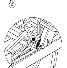
La butée d'arrêt de l'enrouleur se déclenche lors de la pose du tuyau.
